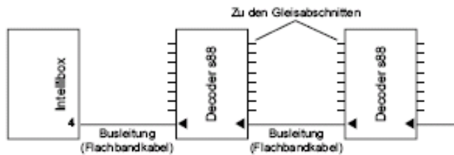
Figur 1.7.2 Tilslutning af flere tilbagemeldingsmoduler til Intellibox
