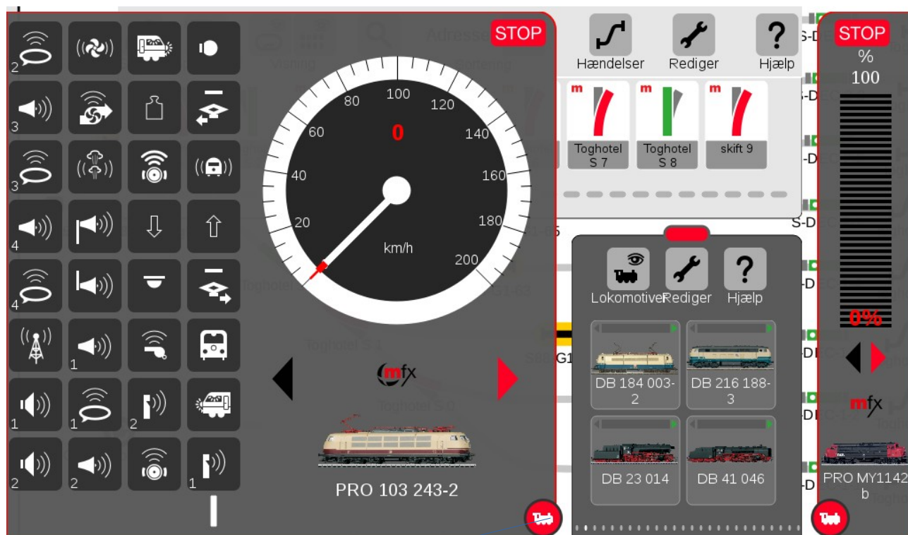
Billedet viser et lokomotiv (PRO 103 243-2) med 32 funktioner, hvor hastigheden vises som et rundt speedometer.
